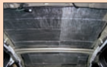
Schotten dicht: Bei Einbauten in Kleinwagen sollte man die Dämmung nicht vernachlässigen – im Clio fanden 25 Meter Alubutyl (1,7 mm) Platz.
