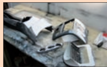
Aus 1 mach 2: Um den Alpine-Moniceiver unterbringen zu können, verwandelten die Nürnberger den 1-DIN-Schacht der Mittelkonsole in einen 2-DIN-Schacht.
