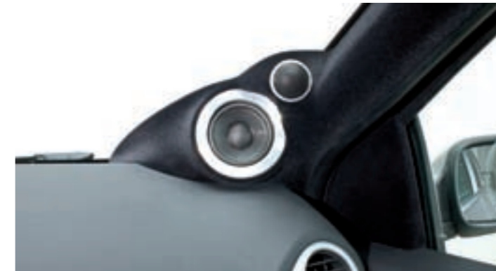
Massive Töne: Weil der schwarz beflochte GFK-Aufbau nicht genügend Volumen für die Mittel- und Hochtöner bietet, dient die A-Säule als Koppelvolumen.
