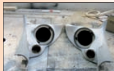
Säulenheilige: Die beiden GFK-Aufbauten der Hoch- und Mitteltoner bietet alleine nicht genug Volumen – hier kommt die komplette A-Säule ins Spiel.
