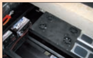
Geschick: Im eng bemessenen Kofferraumboden liefern drei Kove-Batterien SPL 500 Saft – und die Endstufen werden per Ventilator belüftet.
