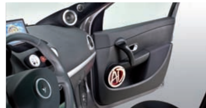
Arbeitsteilung: Die Frontbeschallung übernehmen Hochtöner, Mitteltoner und Tiefmitteltoner von Audio Development. Optisch gibt sich das System dezent.
