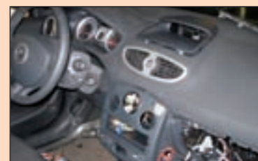
Alles muss raus: Damit die beiden Bildschirme in Armaturenbrett und Mittelkonsole passen, sind massive Umbauten erforderlich.
