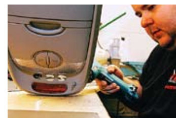
Sein Kollege präpariert die Dachhimmelkonsole für die Freisprecheinrichtung
