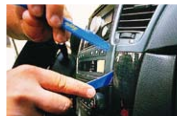
Mit diesen Werkzeugen löst der Spezialist die Doppel-DIN-Blende
