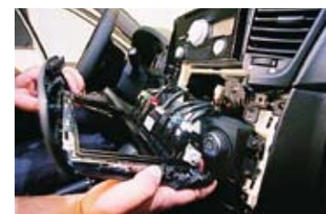
Vor dem Ausbau der Radioeinheit trennt er weitere Tastenelemente von Kabeln
