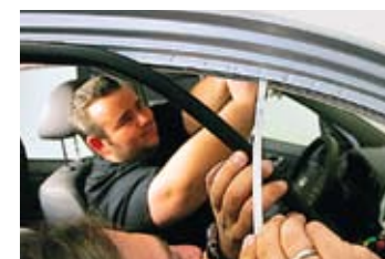
Für die Kabelführung wird der Platz unter dem Beifahrer-Seitenairbag genutzt
