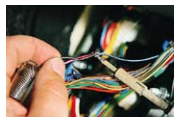
Für das DVD-Navi wird der Speed Pulse (Tachosignal, km/h-Messung) angezapft
