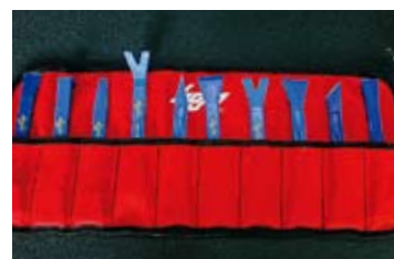
Das Operationsbesteck für den Ausbau: spezielle Kunststoffspachtel
